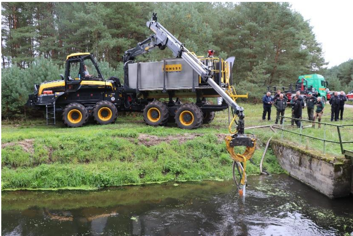
Abb. 1: Die Löschbox der Firma Ponsse verfügt über ein eigenes Pumpensystem zur Befüllung – Voraussetzung dafür ist die Verfügbarkeit von Wasser
